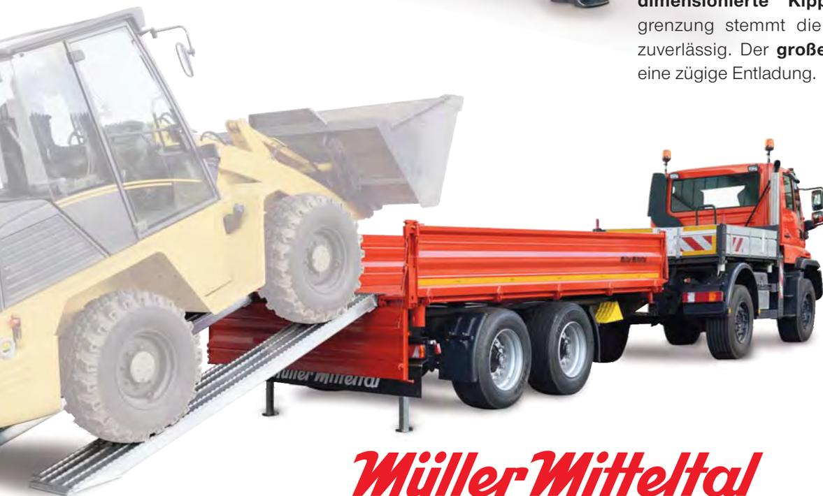
Der KA-TA-RT 18,0 steht wie sein kleiner Bruder für den ganzen Tageseinsatz in der Baugistik. Der Transport des Kleinbaggers geht mit dem KA-TA-RT 18,0 genauso leicht von der Hand wie Schüttgut- und Materialtransporte unterschiedlichster Art. Dabei unterstützt die **niedrige Ladehöhe** ein **einfaches und schnelles Be- und Entladen**. Für die Ladungssicherung sind **6 Paar Zurringe**, über die Ladeflächenlänge verteilt, im **verschleißfesten Stahlboden** eingelassen.
