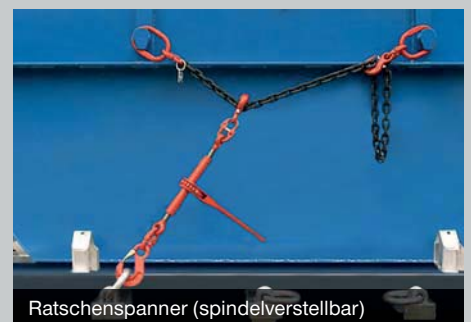
Ratschenspannung am Außenrahmen montiert
