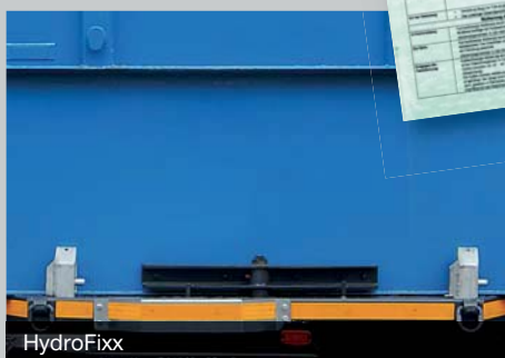
Ratschenspannung am Außenrahmen montiert
