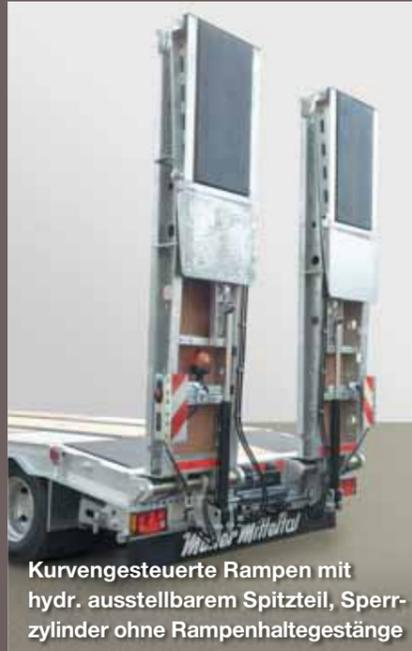
Kurvengesteuerte Rampen mit hydr. ausstellbarem Spitzteil, Sperrzylinder ohne Rampenhaltegestänge
