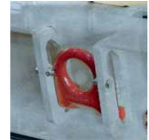
Zurring klappbar im Außenrahmen LC 10.000 daN
