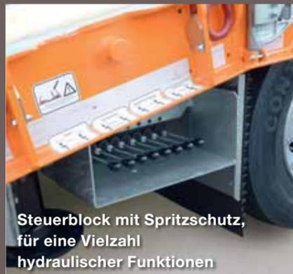
Steuerblock mit Spritzschutz, für eine Vielzahl hydraulischer Funktionen
